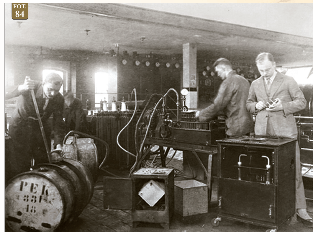
▲ Fot. 84 – Pobieranie próbek oleju i wstępne ich badanie w laboratorium olejowym w Gródku
